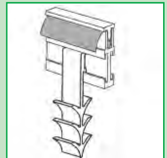
Betonsko pritržilo - sidro
