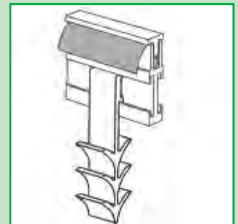
Betonsko pritržilo - sidro
